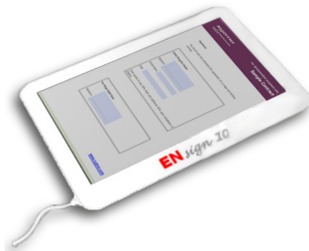
Figura 4.5. EN Sign 10, dispositivo di firma di Euronovate SA (fonte: Euronovate products ).
